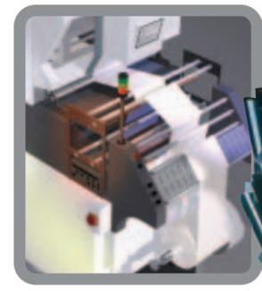
**4** Trieuse pondérale DACS Zenith : un système polyvalent pour un contrôle homogène
